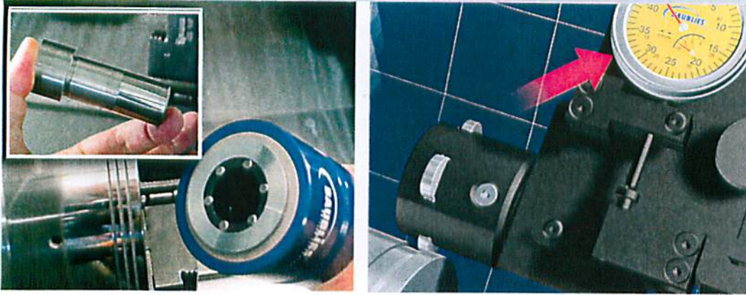
Glattwalz-Werkzeuge: Extrem glatte Oberflächen erzeugen Werkzeuge zum Außenrollieren (Bild links). Das Rollierwerkzeug (Bild rechts) ist für Glattwalzaufgaben beim Innennuten gedacht.
