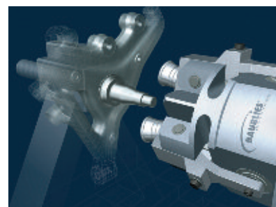
Glätten und Verfestigen: Rollier-Bearbeitung eines Achszapfens.
