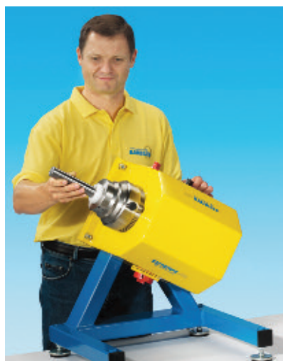
Kompakt und flexibel: Baublies Rolliermaschine RM 2/35 zur Bearbeitung von Außendurchmessern zylindrischer Werkstücke von unbegrenzter Länge im Durchmesserbereich von 2 bis 35 mm im Durchlaufverfahren.
